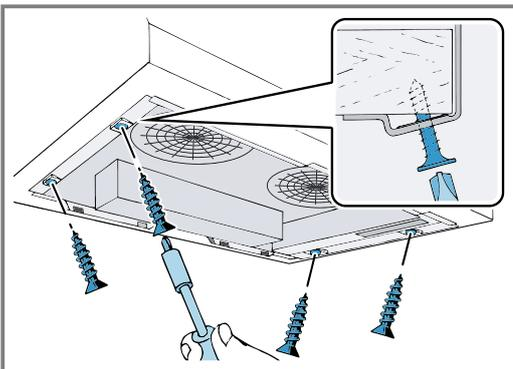
4. Βεβαιωθείτε, ότι η συσκευή ακουμπά στην κάτω ακμή ισόπεδα στη γύρω κατασκευή.
