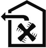
Ο αέρας δεν επιτρέπεται να διοχετεύεται σε μια καμινάδα, η οποία χρησιμοποιείται για τα καυσαέρια συσκευών, που λειτουργούν με αέριο ή άλλα καύσιμα (αυτό δεν ισχύει για συσκευές ανακυκλοφορίας αέρα).
